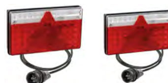
515.04.76.80 MULTILED 2 BASSO DX 12/24V CONNETTORE 7 POLI ASPOCK 515.04.77.80 Fanale biv FULL LED SX versione bassa con il cavo da 0,5m 7 POLI ASPOCK ORIGINAL 515.04.78.80 FANALE POSTERIORE DX ECOPOINT II CON LUCE D'INGOMBRO SUL BRACCIO ASPOCK
